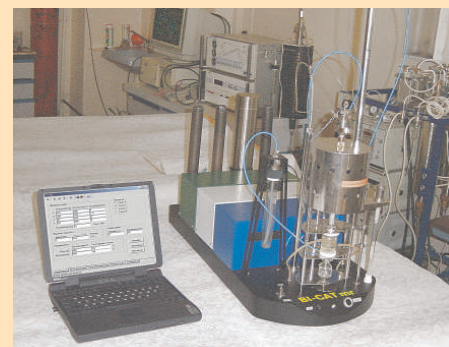
Установка из серии BI-CATr для испытания катализаторов (разработка Института катализа СО РАН)
