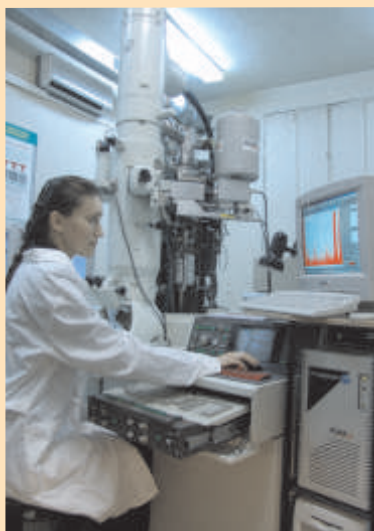
Электронный микроскоп JEM-2010 для изучения структуры поверхности дисперсных порошковых материалов
