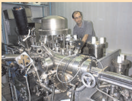
Электронный спектрометр VG TSCALAB HP для исследования состава и состояния поверхности твёрдых материалов
